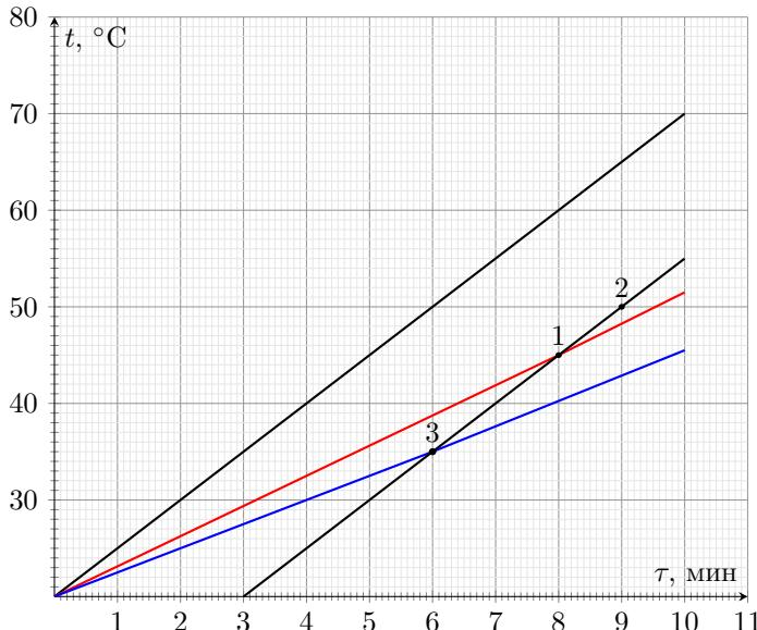
они лежат, должны быть параллельны, так как мощность нагрева постоянна. Проведем прямую, параллельную нашей и проходящую через начало координат (время — 0 мин, температура —  $20\text{ }^{\circ}\text{C}$ ). Именно на этой прямой лежит график первого участка. По ней также можно определить температуру  $t_k$ , которую имела бы вода в кастрюле, если бы её масса не менялась со временем. Температура, соответствующая 10 минутам и есть искомая  $t_k = 70\text{ }^{\circ}\text{C}$ .
