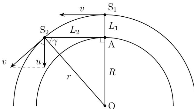
Теперь перейдем к локации на горизонте. Радиус Земли обозначим как  $R$ . Тогда расстояние до спутника можно получить из теоремы Пифагора:
