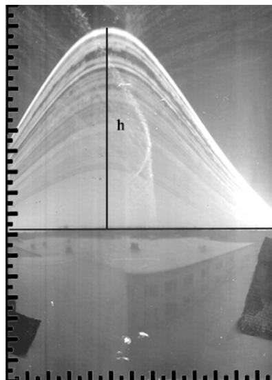
Горизонт на снимке отчетливо виден и едва заметно изогнут. Это произошло из-за не очень точной ориентации банки в вертикальном положении и дает небольшую погрешность при измерениях, которую нам не нужно оценивать. Проведем горизонт с помощью линейки. Измерим расстояние от горизонта до верхней точки самого высокого солнечного трека и получим
